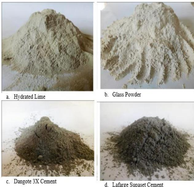
**Figure 1:** (a) Hydrated Lime (b) Glass Powder (c) Dangote3 X Cement (d) Lafarge Supaset Cement.
